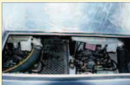
El acceso al compartimento de motores se realiza mediante una gran tapa insonorizada que ocupa la mayor parte de la cubierta de bañera.
