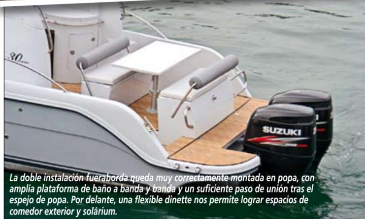
La doble instalación fueraborda queda muy correctamente montada en popa, con amplia plataforma de baño a banda y banda y un suficiente paso de unión tras el espejo de popa. Por delante, una flexible dinette nos permite lograr espacios de comedor exterior y solárium.
