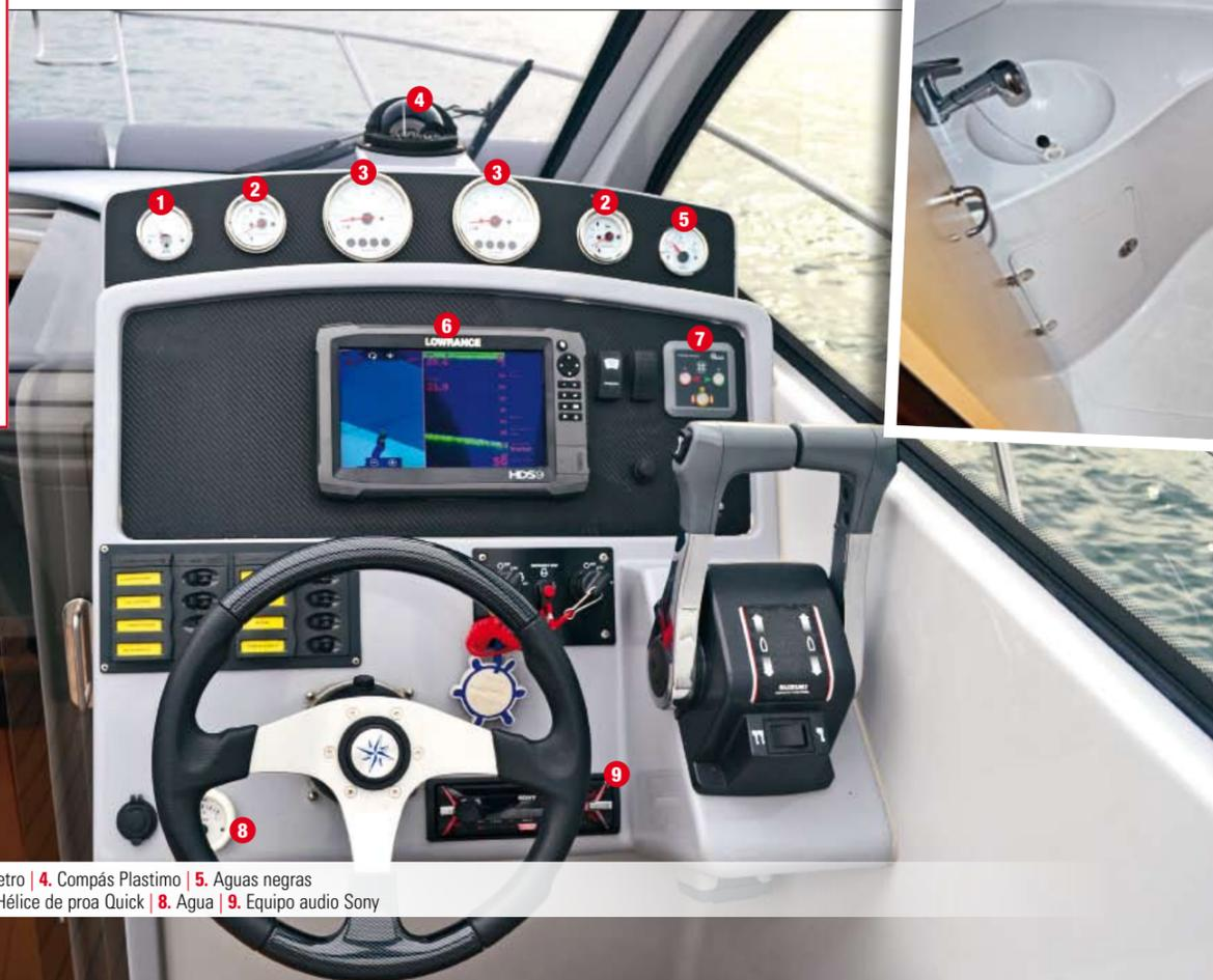
1. Combustible | 2. Trim | 3. Suzuki: tacómetro | 4. Compás Plastimo | 5. Aguas negras | 6. GPS-plotter sonda Lowrance HDS9 | 7. Hélice de proa Quick | 8. Agua | 9. Equipo audio Sony
